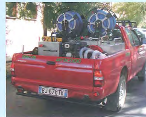
Modulo AIB con serbatoio in acciaio
