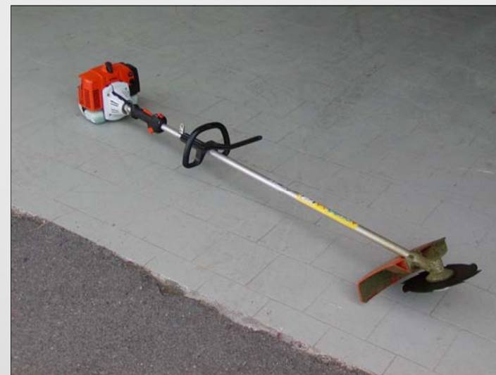
Modello di decespugliatore a disco impiegato per eliminare la vegetazione erbacea ed arbustiva lungo la fascia di controllo .
