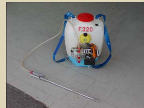
Modello di motopompa spalleggiata con motore a scoppio monocilindrico, a due tempi, raffreddato ad aria
