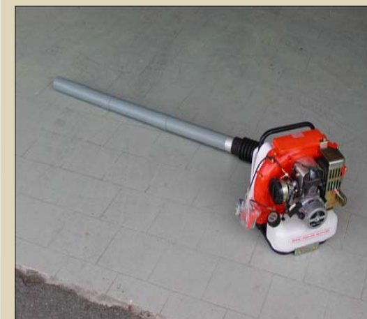
Modello di soffiatore spalleggiato con motore monocilindrico, a due tempi, raffreddato ad aria
