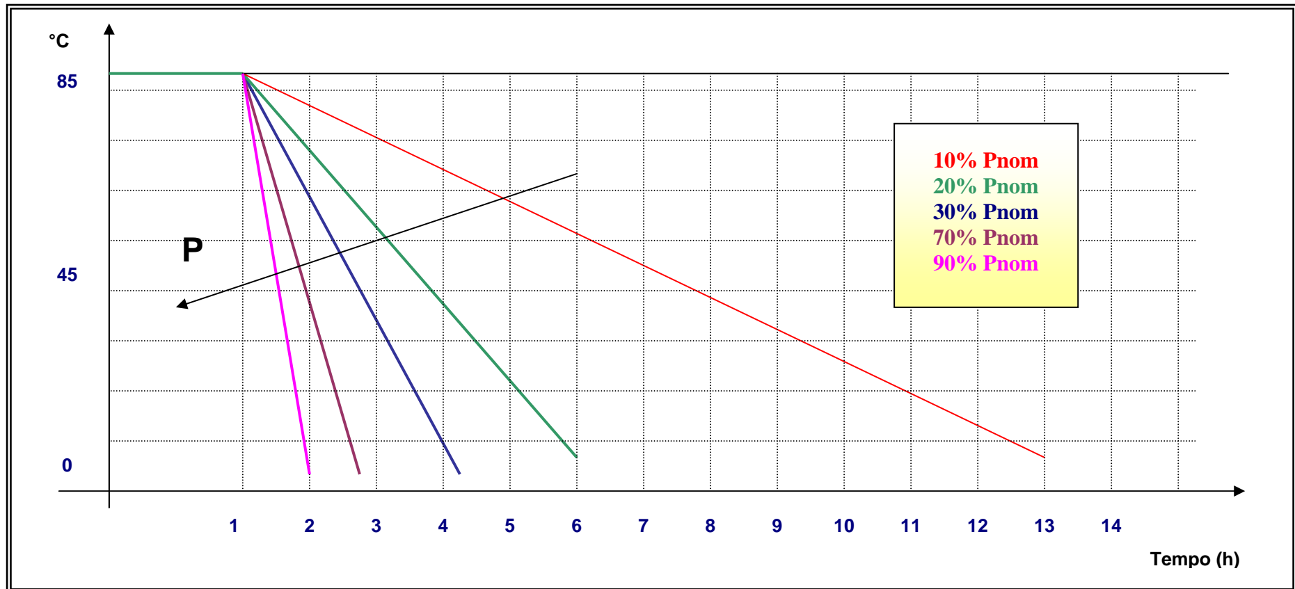
Figura M.5: Analisi di sensitività dei blocchi in funzione della potenza termica richiesta nell'impianto di Rossiglione
