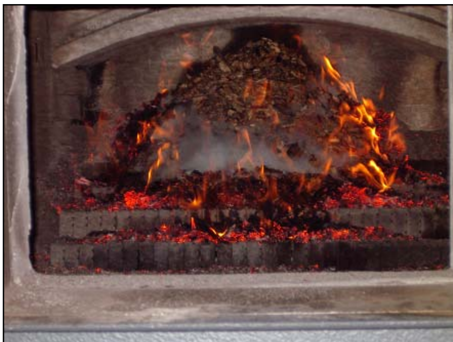
Figura 5: La camera di combustione
