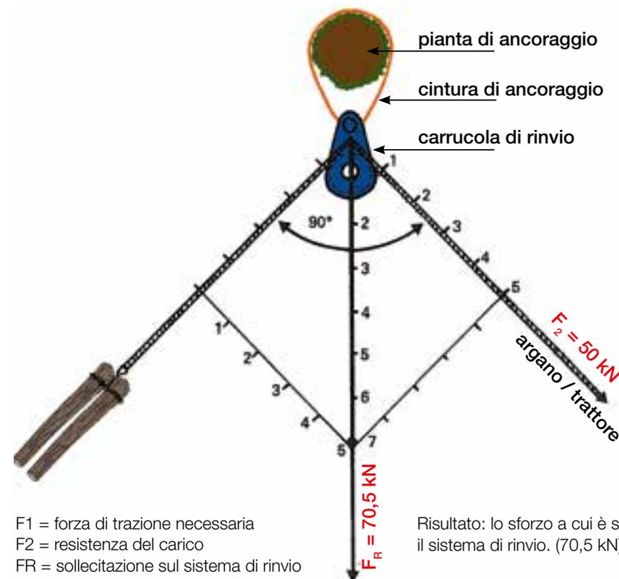
**ATTENZIONE: TUTTA L'ATTREZZATURA UTILIZZATA (CARRUCOLE, CATENE, FUNI, CINTURE) DEVE ESSERE DIMENSIONATA IN BASE ALLA FORZA DI TRAZIONE E ALLE MODALITÀ DI UTILIZZO (PARALLELOGRAMMA DELLE FORZE)**
