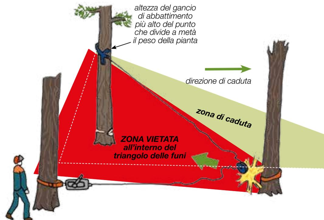
ricolo di rottura della carrucola, della sua cintura di ancoraggio e delle funi. L'operatore deve azionare il paranco stando sempre all'esterno di questa zona.
