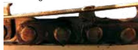
Per mantenere un'efficienza elevata di taglio va controllata l'altezza del limitatore di profondità abbassandola in modo proporzionale rispetto al dente tagliente (da 0,5 a 1 mm).
