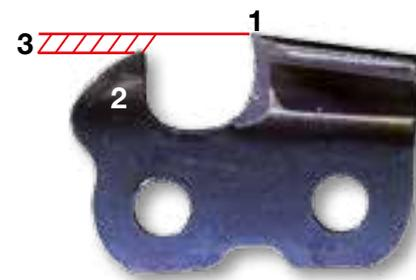
Nell'avanzamento della catena, il limitatore di profondità precede il dente tagliente, ne regola la profondità di penetrazione e di conseguenza determina lo spessore del truciolo. La corretta altezza del limitatore di profondità influenza direttamente la resa di taglio della motosega.
