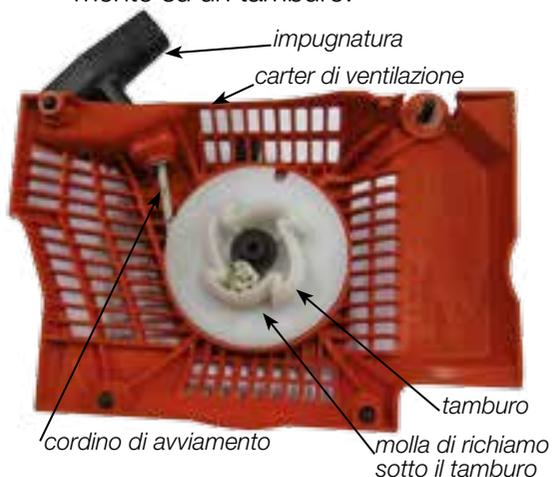
Si consiglia di avere sempre un cordino di avviamento di scorta per poterlo sostituire in caso di necessità.
