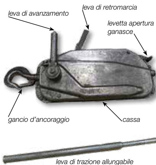
I paranchi hanno generalmente una sicurezza alla base della leva di avanzamento; essa serve per impedire che, forzando sulla leva di avanzamento per effettuare trazioni eccessive, il paranco si danneggi. Il meccanismo di sicurezza è dato da copiglie poste alla base della leva stessa, che si rompono se sovraccaricate.
