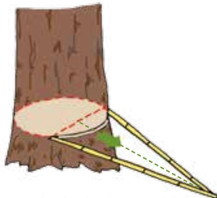
Conoscendo la larghezza della barra di guida, si determina con buona precisione la profondità della tacca.
