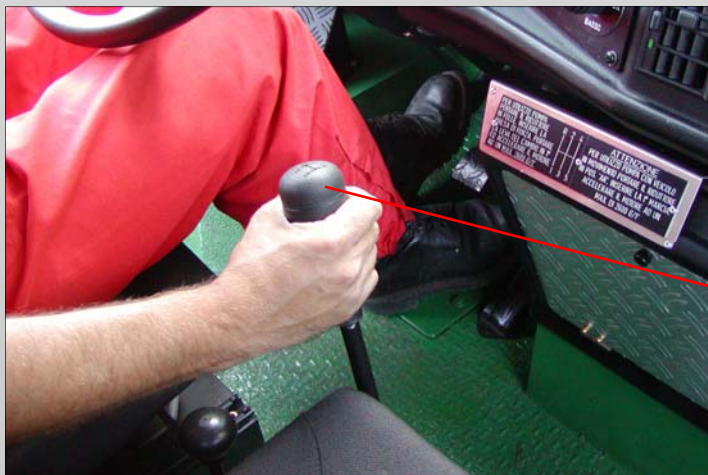
Leva del cambio: Dopo avere messo il riduttore in folle e aver inserito la presa di forza si può mettere il cambio in 1°
