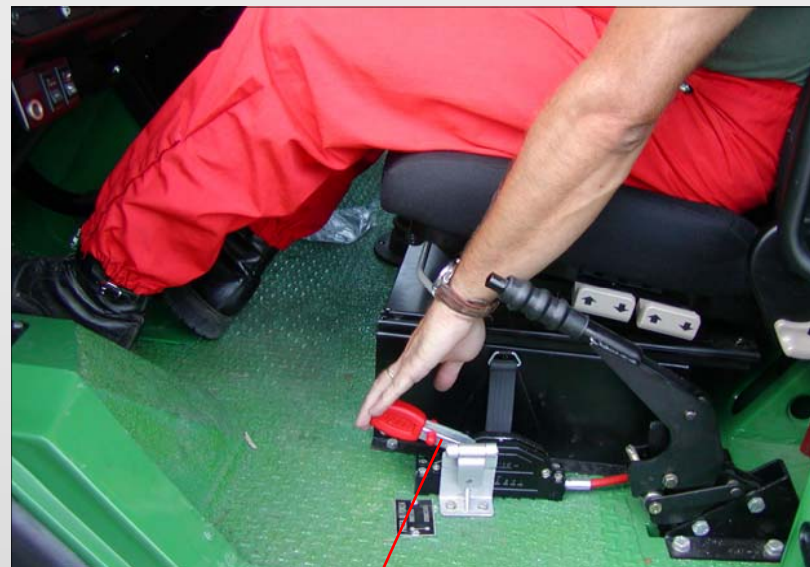
Pres a di forza inserita Ora la pompa è collegata al motore dell'automezzo. NB: l'acceleratore è ancora al minimo.
