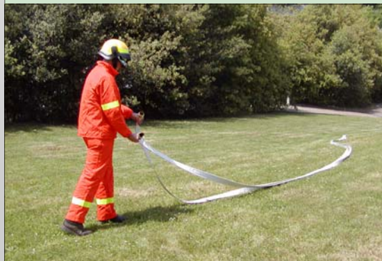
il raccordo femmina resta all'operatore che lo attacca alla presa d'acqua
