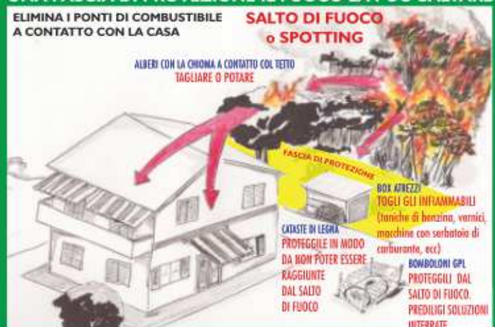
FASCIA DI PROTEZIONE RIDUCI IL CARICO DI COMBUSTIBILE MAN MANO CHE TI AVVICINI ALLA CASA
